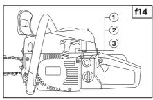
по часовой стрелке, чтобы найти положение, при котором обороты холостого хода максимальны, затем установите иглу назад на четверть (1/4) оборота против часовой стрелки.
